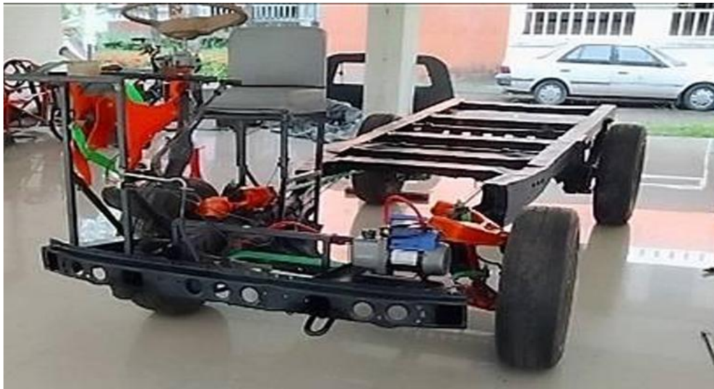
รูปที่ 3 ชุดฝึกอบรมรองรับและเครื่องล่างรถยนต์ โตโยต้า ไฮเอซ
