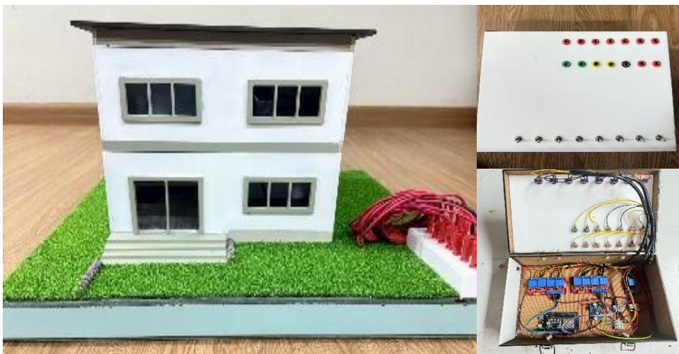
รูปที่ 9 ชุดจำลองบ้านอัจฉริยะที่สร้างตามแบบ และติดตั้งอุปกรณ์ควบคุม
